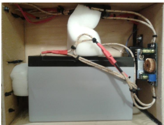
Первая ступень преобразования (40 В).
