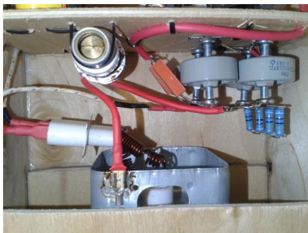
Высоковольтный блок питания.
